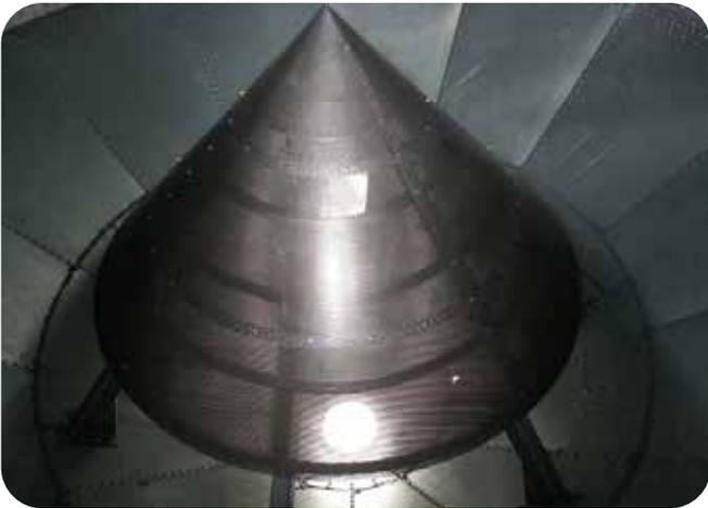
En su interior se monta un **tobogán de descarga** para evitar la rotura de la almendra en la caída y un **contracono completamente perforado** con una conexión para la entrada de aire. Este contracono también hace posible que la **descarga** del producto sea según el principio **FIFO** (lo primero que entra es lo primero que sale).
