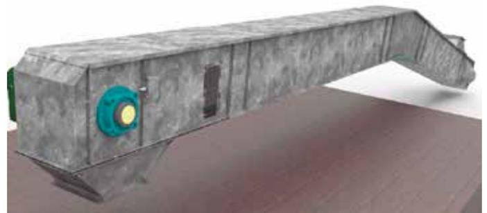
**Ejemplo 4.** Partiendo de la carga del transportador en posición inclinada se pueden salvar obstáculos y continuar el transporte en horizontal.
