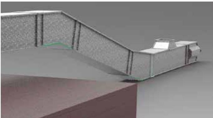
**Ejemplo 3.** Se pueden salvar obstáculos de desnivel y posteriormente volver a colocar el transportador en posición horizontal.
