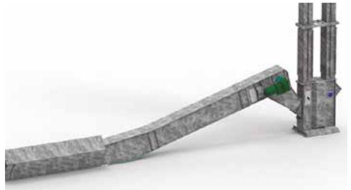
**Ejemplo 2.** Conexión del transportador de piqueta al elevador disminuyendo la profundidad del foso. Con esta posibilidad se evita la necesidad de realizar obra civil y permite colocar el elevador al mismo nivel que el transportador de cadena.
