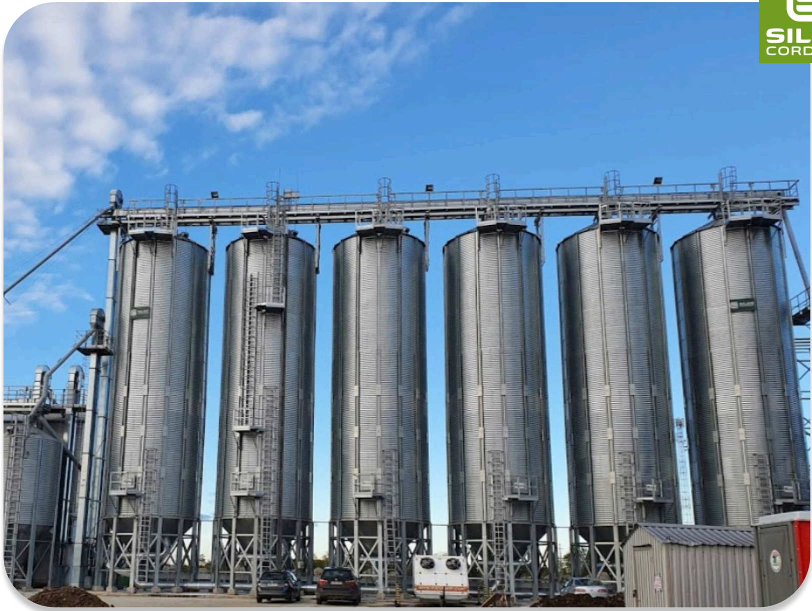
2020 VITAM - HUNGRÍA: 6 Hopper silos mod. 5,35/14 – Total Capacity: 1,900 T
